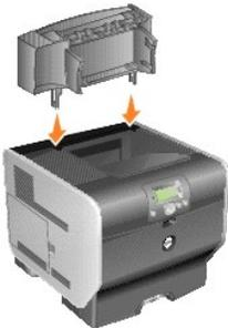
4. プリンタまたは別の排紙増量器に排紙増量器を取り付ける場合は、ワイヤ仕切りを取り付けます。ワイヤ仕切りがカーブして下に向くような形で、プラスチックブラケットの端にワイヤ仕切りの端を差し込みます。
