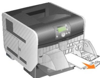
封筒がプリンタに詰まって抜けない場合は、封筒フィーダごと取り外します。
