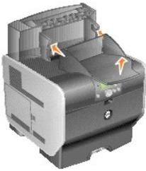
6. 上部のタブが上部のスロットにカチッと入るまで、カセットを回転させるように持ち上げます。
