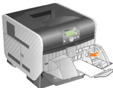
7. 紙の束に触れるように、封筒押さえを引き下げます。
